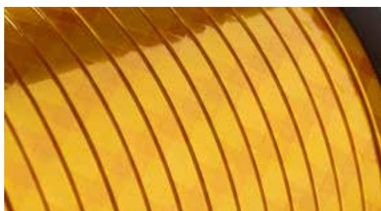
扁铝线由两层SynTherm® H绕包绝缘，方向相反，25%重叠
