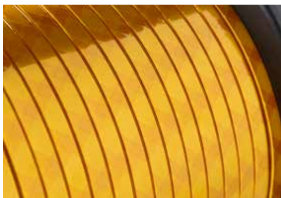
Méplat aluminium guipé 2 couches Syntherm H croisés 25% de recouvrement
