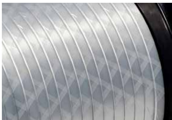
Méplat aluminium émaillé guipé 2 couches Syntherm P croisés 20% de recouvrement
