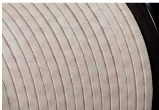
Méplat cuivre guipé 2 couches Syntherm YT510-50 croisés 30% de recouvrement
